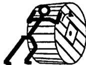
Rodar la bobina en la dirección utilizada durante el bobinado del cable
