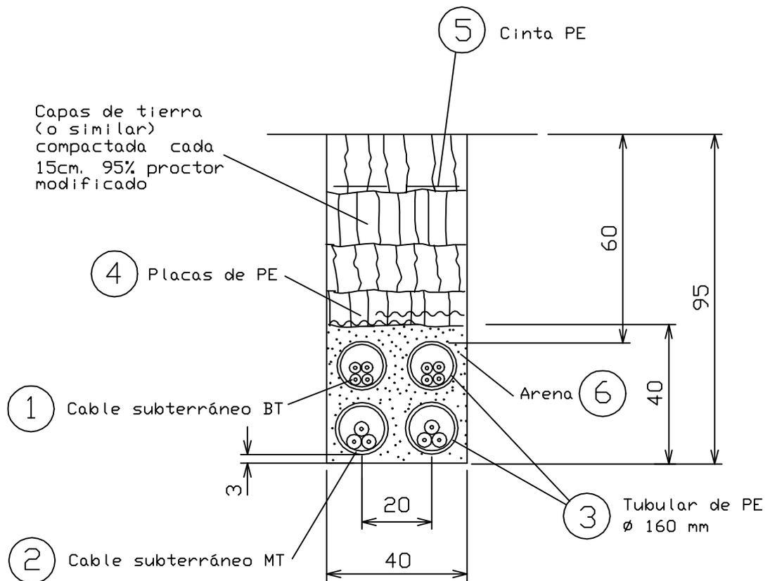
NOTA: A UTILIZAR CUANDO SE INSTALAN SIMULTANEAMENTE 1 ó 2 CIRCUITOS DE MT CON 1 ó 2 CIRCUITOS DE BT.
