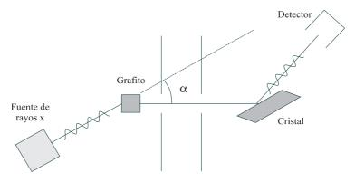
La radiación generada por una fuente de rayos X es dispersada por el grafito. El colimador permite estudiar la radiación dispersada bajo un ángulo  $\alpha$ . Por último, el cristal nos permite, mediante la reflexión de Bragg, estudiar la composición de la radiación dispersada en longitudes de onda. Lo que Compton encontró experimentalmente es lo que se muestra en la siguiente figura.
