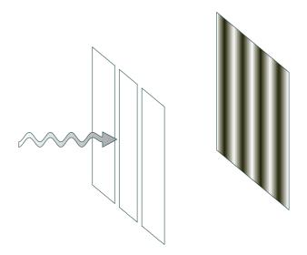
De acuerdo con la naturaleza corpuscular de la radiación el patrón de interferencia tiene que ser discreto y no continuo como suponen las teorías clásicas. Vamos a suponer que la pantalla es una placa fotográfica en la que se imprime el patrón de interferencia. Si miramos la placa con detalle con un microscopio lo que veremos es una serie de puntos, de modo que efectivamente el patrón de interferencia es discreto, como se muestra en la siguiente figura.
