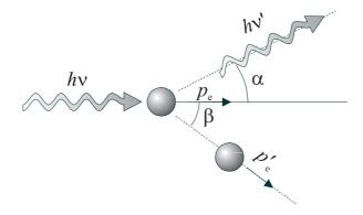
Inicialmente el electrón tiene un momento lineal  $p_e$  y después de la colisión  $p'_e$ . Podemos aplicar los principios de conservación de forma análoga al caso anterior. El principio de conservación del momento lineal vendrá dado por las siguientes dos ecuaciones:
