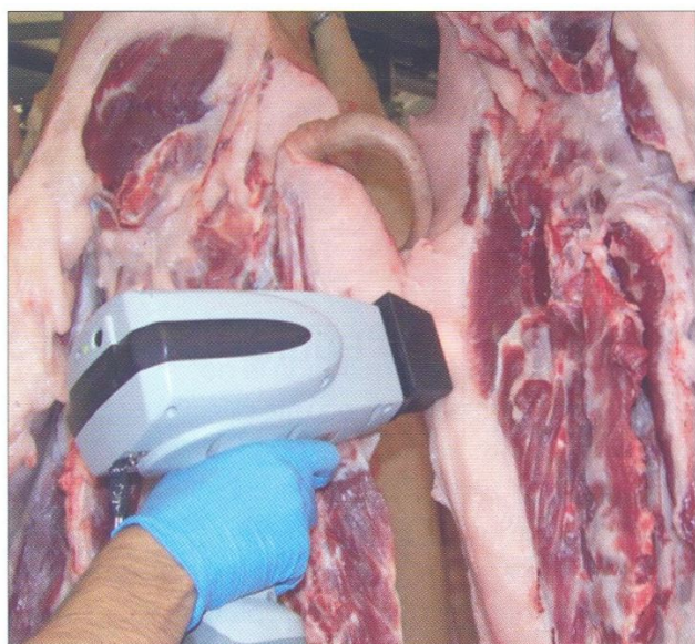
Figura 1. Análisis in situ de canales de cerdo ibérico en la línea de faenado mediante sensores MEMS-NIRS
