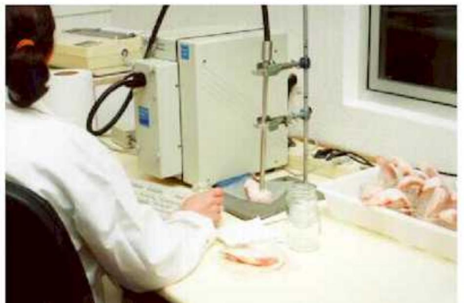
Fig. 3. Equipo NIRS para la obtención de espectros de tocino de cerdo Ibérico
