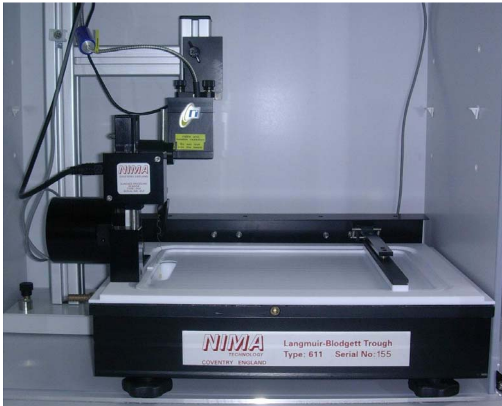
Figura 5. Balanza de Langmuir, para la deposición de películas ultrafinas
