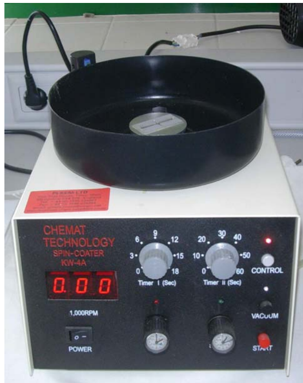
Figura 4. Equipo para preparar películas por rotación
