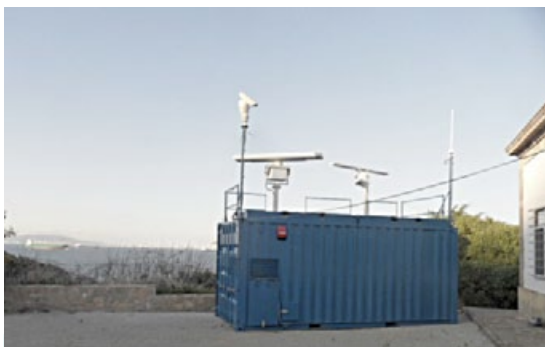
Vista del sistema radar montado en un contenedor de 20 pies
