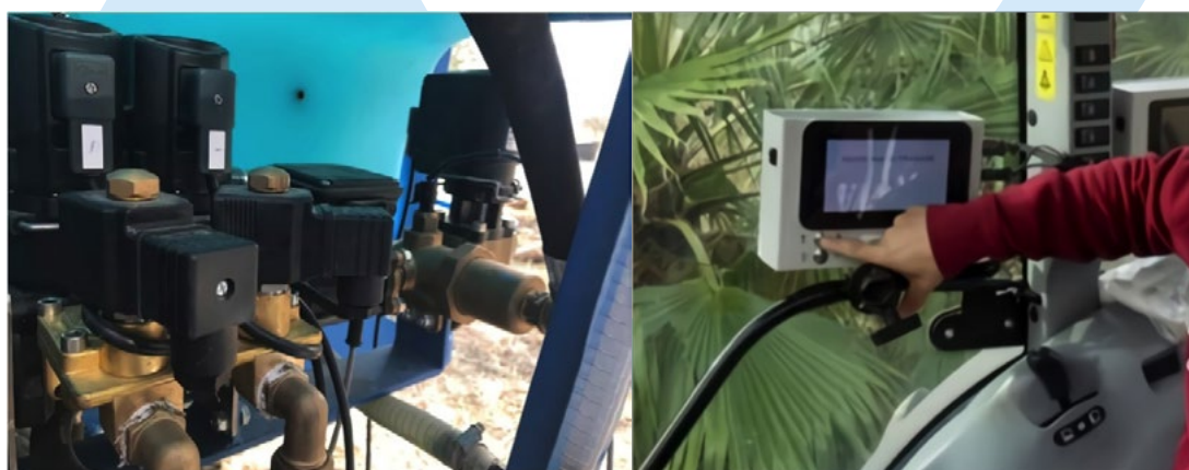
Figura 3. Kit de sensores y válvulas montados en el atomizador y display de visualización.
