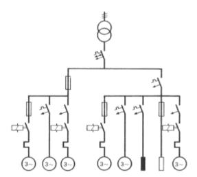
Así, según vemos en la figura, inmediatamente después del transformador tenemos un interruptor automático, dividiéndose el circuito en dos ramales, con sendas derivaciones a motores y resistencias de calefacción. Hasta llegar a los receptores, existen una serie de protecciones selectivas y en cada uno de estos puntos deberemos calcular la intensidad de cortocircuito para poder dimensionar correctamente cada una de las protecciones.
