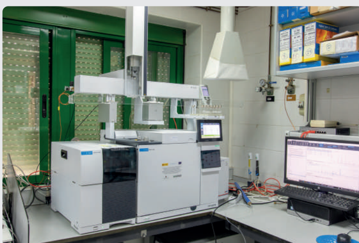
CROMATÓGRAFO DE GASES ACOPLADO A UN ESPECTRÓMETRO DE MASAS Y UN ESPECTRÓMETRO DE MOVILIDAD IÓNICA (GC-MS-IMS)
