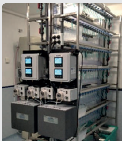
RACKS DE 6 NIVELES DE ESTABULACIÓN (CON PECERAS DE DIFERENTES TAMAÑOS), DISPENSADOR AUTOMÁTICO DE SALES, CONTROL SIMULTÁNEO DE PH Y CONDUCTIVIDAD Y UN TANQUE ACUMULADOR DE AGUA DE ÓSMOSIS
