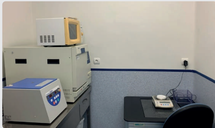
ZONA DE PREQUIRÓFANO (DESINFECTADORA, ESTERILIZADOR DE VAPOR, SELLADORA Y BALANZA DE PRECISIÓN)
