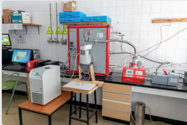
ANALIZADOR VOLUMÉTRICO PCT-PRO HASTA 200 ATMÓSFERAS DE PRESIÓN
