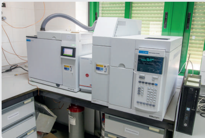
CROMATÓGRAFO DE GASES ACOPLADO A DETECTORES DE IONIZACIÓN DE LLAMA, DE CAPTURA DE ELECTRONES Y DE ESPECTROMETRÍA DE MOVILIDAD IÓNICA
