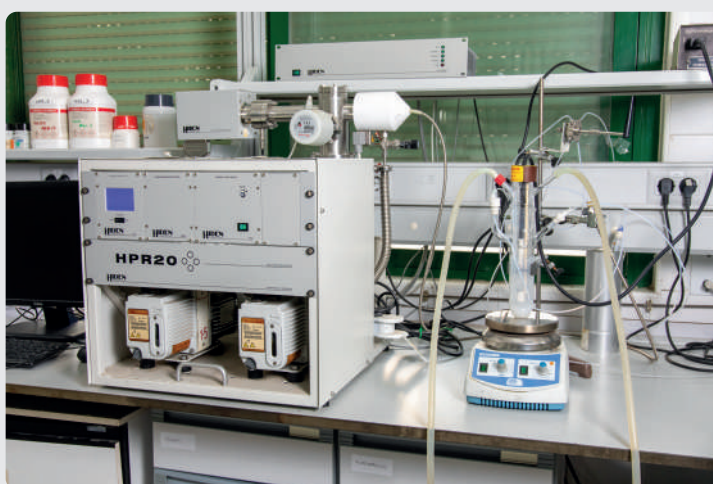
SISTEMA DE REACCIÓN DE FOTOCATÁLISIS CON LÁMPARA ULTRAVIOLETA ACOPLADO A UN ESPECTRÓMETRO DE MASAS
