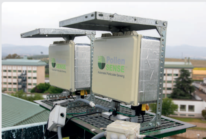
POLLENSENSE-CAPTADOR DE POLEN Y ESPORAS AUTOMÁTICO BASADO EN IMÁGENES DIGITALES
