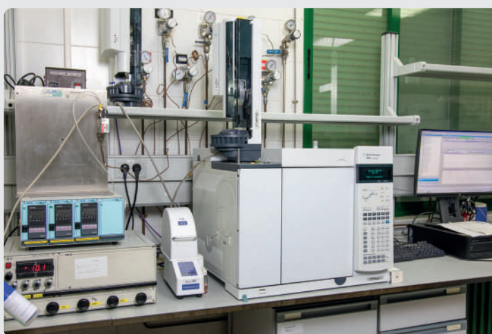
SISTEMA DE REACCIÓN DE FOTOCATÁLISIS ACOPLADO A CROMATÓGRAFO DE GASES
