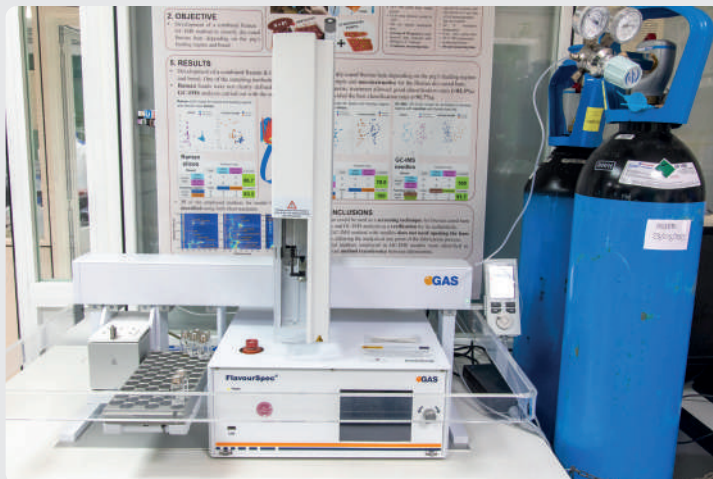
FLAVOURSPEC (ESPECTROMETRÍA DE MOVILIDAD IÓNICA CON FUENTE DE IONIZACIÓN DE TRITIO ACOPLADA A COLUMNA DE GC)
