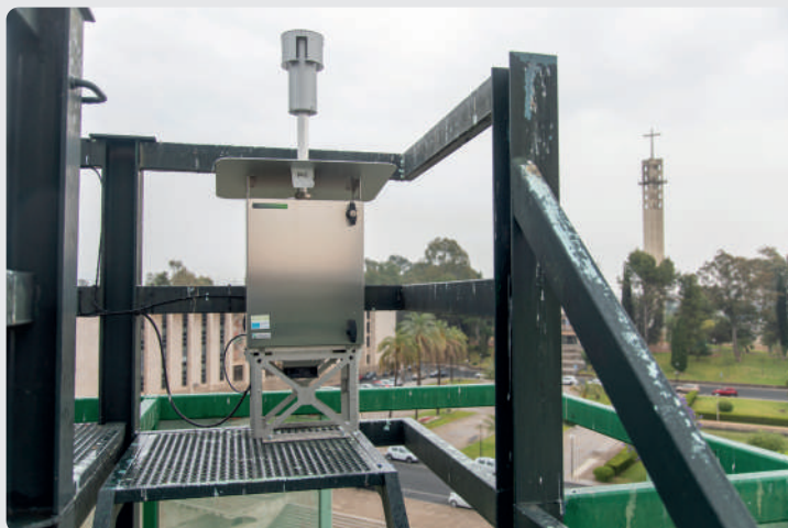
POLENO- CAPTADOR DE POLEN Y ESPORAS AUTOMÁTICO BASADO EN HOLOGRAFÍAS
