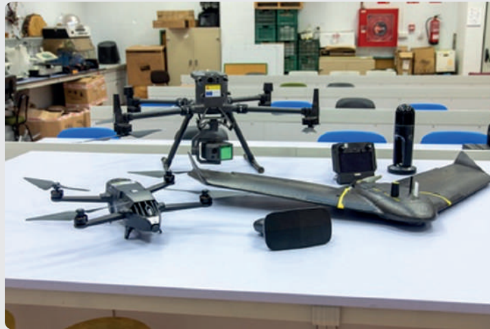
EQUIPAMIENTO DE DRONES Y LIDAR TERRESTRE PARA INVENTARIOS FORESTALES DE ALTA PRECISIÓN
