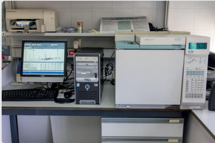
CROMATÓGRAFO DE GASES CON DETECTOR FID PARA VOLÁTILES
