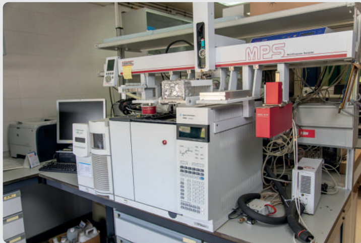
PLATAFORMA MULTIANÁLISIS SBSE-GC-MS-MPS (ANÁLISIS DE AROMAS)
