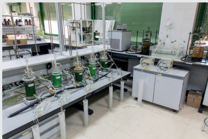
BATERÍA REACTORES ANAERÓBIOS
