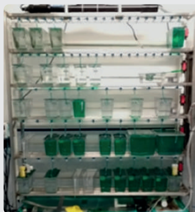
RACKS DE 6 NIVELES DE ESTABULACIÓN (CON PECE- RAS DE DIFERENTES TAMAÑOS) PARA LA CRÍA Y MAN- TENIMIENTO DE PECES
