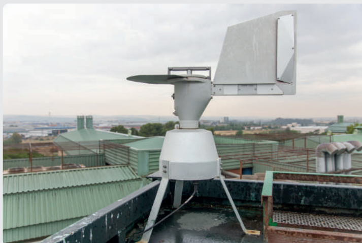
CAPTADOR MANUAL TIPO HIRST DE POLEN Y ESPORAS
