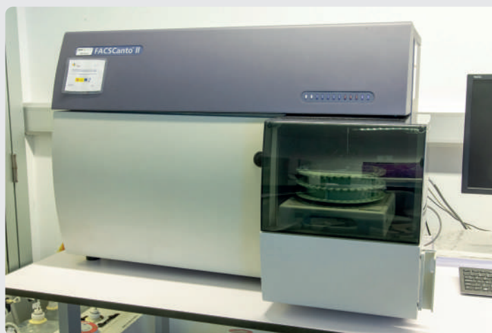
CITÓMETRO ANALIZADOR QUE MIDE 10 PARÁMETROS
