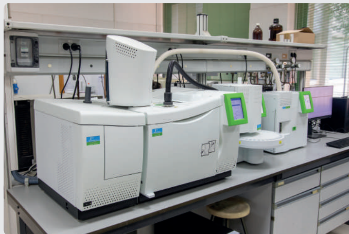
CROMATÓGRAFO DE GASES-ESPECTRÓMETRO DE MASAS DE SIMPLE CUADRUPOLO
