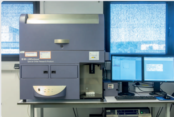
CITÓMETRO ANALIZADOR QUE MIDE 20 PARÁMETROS
