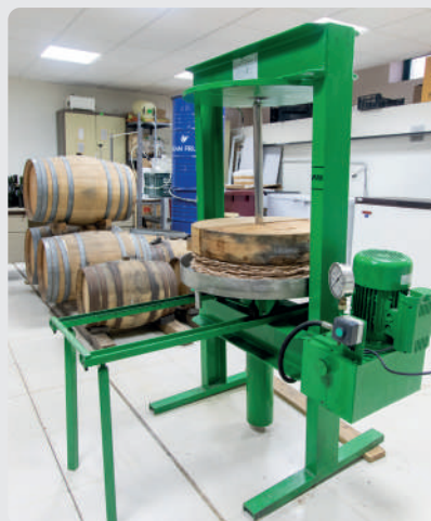
PRESA VERTICAL QUE PUEDE ALCANZAR UNA PRESIÓN MÁXIMA DE 400 BARES
