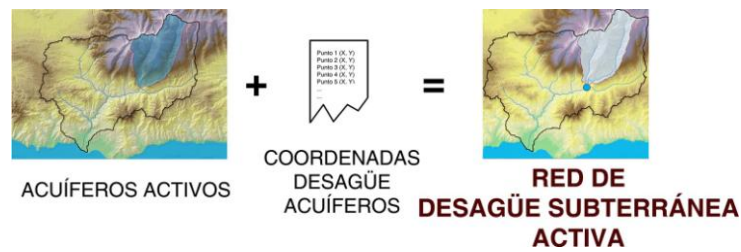
Figura 51. Esquema de la determinación de la red de desagüe subterránea activa y de sus celdas vertientes.
